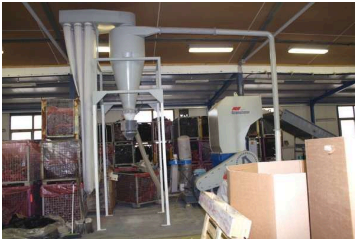
Obrázek č. 8 – Pohled na nožový mlýn AVIAN s odsáváním a filtrací vzdušiny
